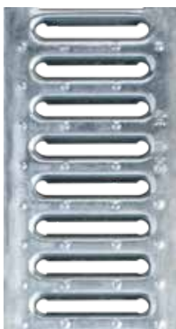
GRIGLIA ACCIAIO INOX AD ASOLE ANTITACCO FESSURA 8x82 B125 dimensioni: 124x20x1000 mm
