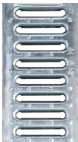
GRIGLIA ZINCATA AD ASOLE ANTITACCO FESSURA 8x82 A15 dimensioni: 124x20x1000 mm
